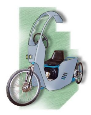
Le prototype 002 est actuellement en cours de réalisation. Ce véhicule découle des précédentes études sur le prototype 001. Il en garde l'essentiel des options techniques (moteur, transmission...) mais, est résolument tourné vers la recherche d'autonomie. La bouteille embarque cette fois 126 litres à 200 Bars
