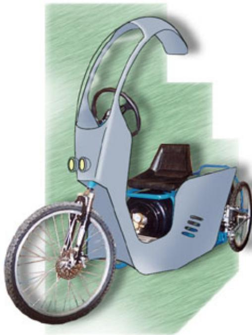
Le prototype 002 est actuellement en cours de réalisation. Ce véhicule découle des précédentes études sur le prototype 001. Il en garde l'essentiel des options techniques (moteur, transmission...) mais, est résolument tourné vers la recherche d'autonomie. La bouteille embarque cette fois 126 litres à 200 Bars
